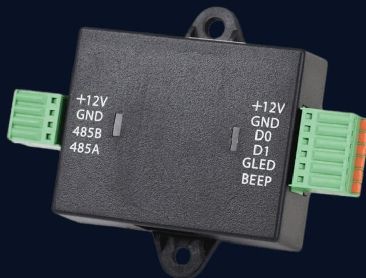
Преобразователь Wiegand (26-bit) в RS485, для подключения считывателей к С2-260.
